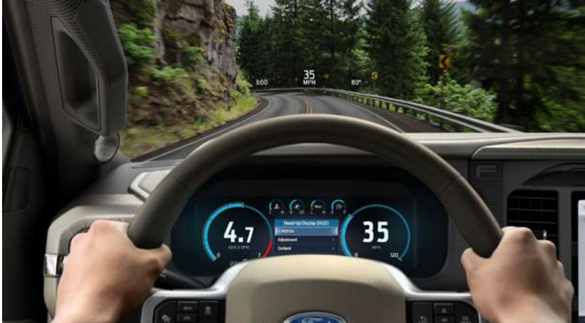
Head up display: tecnologia que projeta as informações do veículo diretamente no parabrisa.
