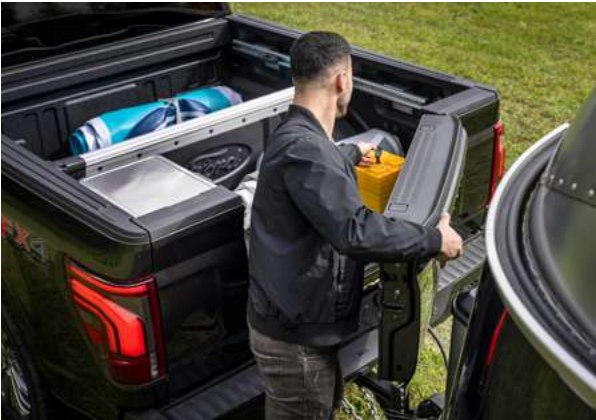
Caçamba revestida com iluminação, tomada 12V, nichos com trava e abertura lateral multiacesso (Pro-Access).
