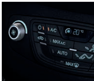
Klimatyzacja z automatyczną regulacją temperatury (EATC)
