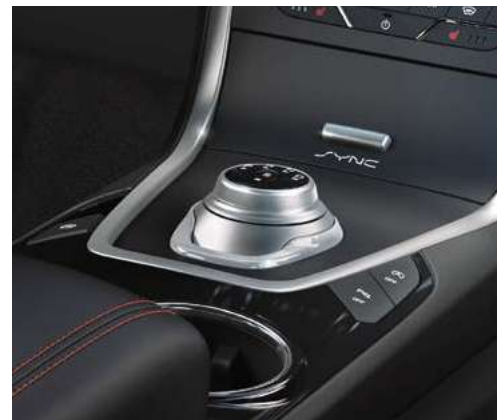
E-shifter - pokrętło sterowania automatyczną skrzynią biegów
