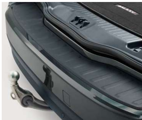
Hak holowniczy - składany elektrycznie
