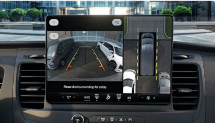
SYSTEM KAMER 360 STOPNI
