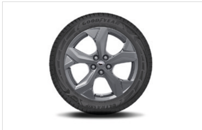
KOMPLETNE KOŁA ZIMOWE ALUMINIOWE 18" Z OPONAMI GOODYEAR UG PERF SUV G1 XL, 225/60 R18 104V (2 485 238)
