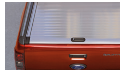
Aluminiowa roleta skrzyni ładunkowej, zamykana na klucz
