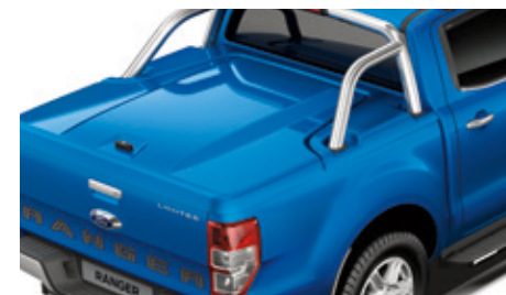
Twarda pokrywa skrzyni ładunkowej z tworzywa
