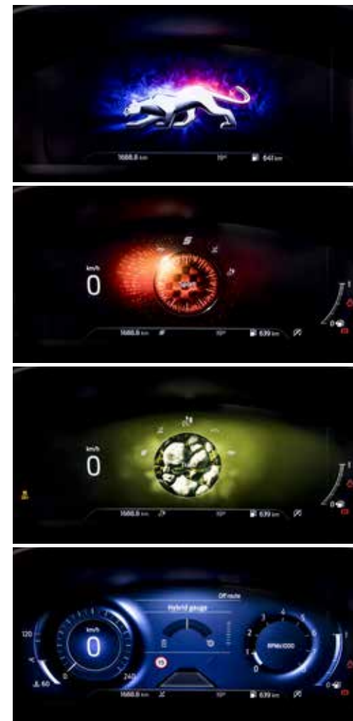
12.3 - calowy, konfigurowalny wyświetlacz na tablicy zegarów
