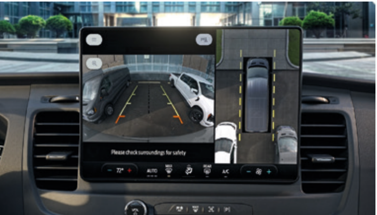
SYSTEM KAMER 360 STOPNI
