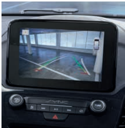
Kamera cofania z obrazem wyświetlanym na ekranie systemu audio
