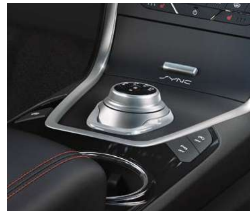
E-shifter - pokrętło sterowania automatyczną skrzynią biegów
