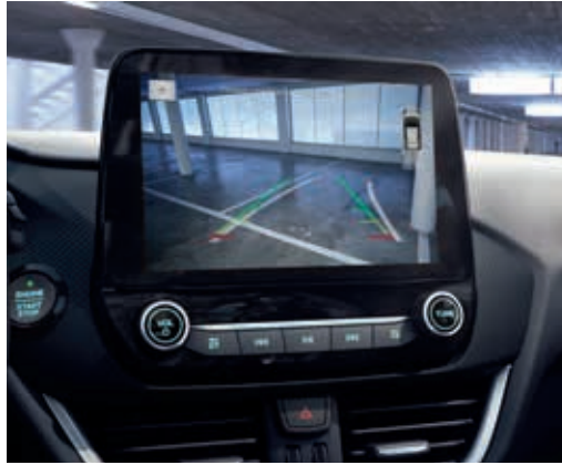
Kamera ułatwiająca parkowanie tyłem z szerokim kątem widzenia
