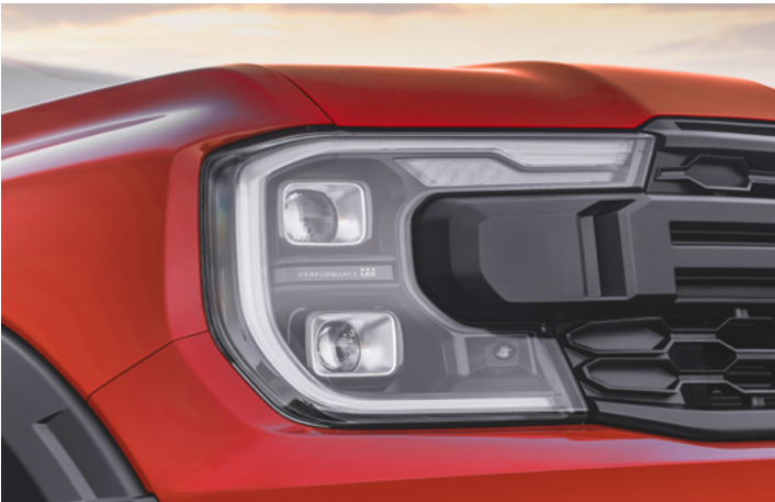
MATRYCOWE, ADAPTACYJNE REFLEKTORY W TECHNOLOGII LED Standard w wersji Raptor
