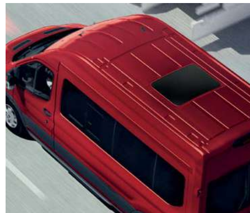
Okno dachowe w kabinie - nieotwieranie
