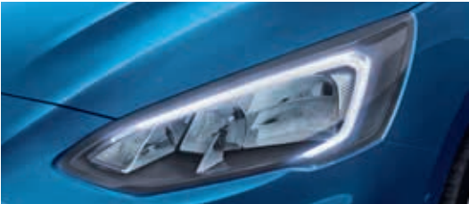
Reflektory LED ze światłami do jazdy dziennej LED oraz światłami drogowymi halogenowymi
